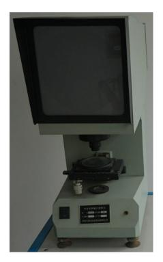
应用:用于判断冲击试样 V、U 型缺口的几何尺寸加工质量。
