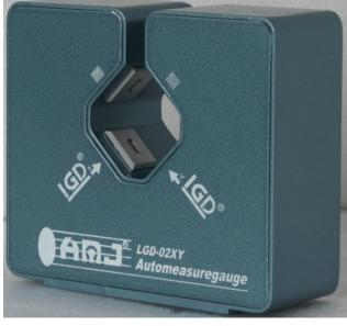
特点:该系列激光测径仪是奥美加公司 引进国外先进技术开发设计并生产的新 一代测径仪。采用激光扫描技术,具有 测量范围广、精度高、使用寿命长、性 能稳定等特点。测量范围: 0.02~2.000 毫米,测量精度±0.0005毫米。
